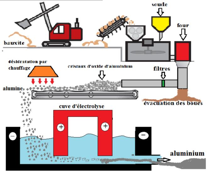
L'aluminium passe ensuite dans une station d'affinage, avant sa transformation au laminage en produit.
