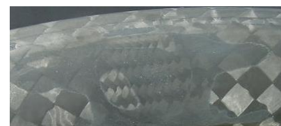
Pièce carbone réparée Lycée Gaston BARRÉ RD
