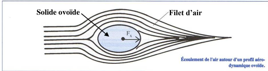
Lors des essais en soufflerie, on soumet le véhicule à l'arrêt à un violent courant d'air animé d'une vitesse  $V$ . On obtient ainsi une action de l'air équivalente à celle qui s'opposerait à l'avancement d'un véhicule se déplaçant sur une route à cette même vitesse  $V$ , mais par vent nul.
