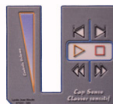
Circuit imprimé avec son "habillage". Diélectrique formé de papier plastifié
