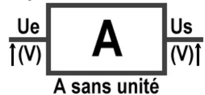
1. Pour un réducteur de vitesse, à engrenages, poulies-courroie ou pignons-chaîne... (*les grandeurs d'entrée et de sortie sont des vitesses de rotation*) :
