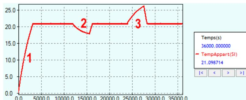
**Repère 1** : Durée de la montée en température (*de l'ordre de 3600 s*) liée aux caractéristiques du studio (*dont la constante de temps est :  $t_{th} = R_{th} \times C_{th} \approx 3600$  s*), à la puissance de chauffage (1200 W), à la température de consigne (21 °C) et aux conditions météo (*Temp. extérieure = -5 °C*). A noter que la température est atteinte et maintenue sans aucun dépassement dans les conditions normales (*caractéristique classique d'un système bouclé du premier ordre*).
