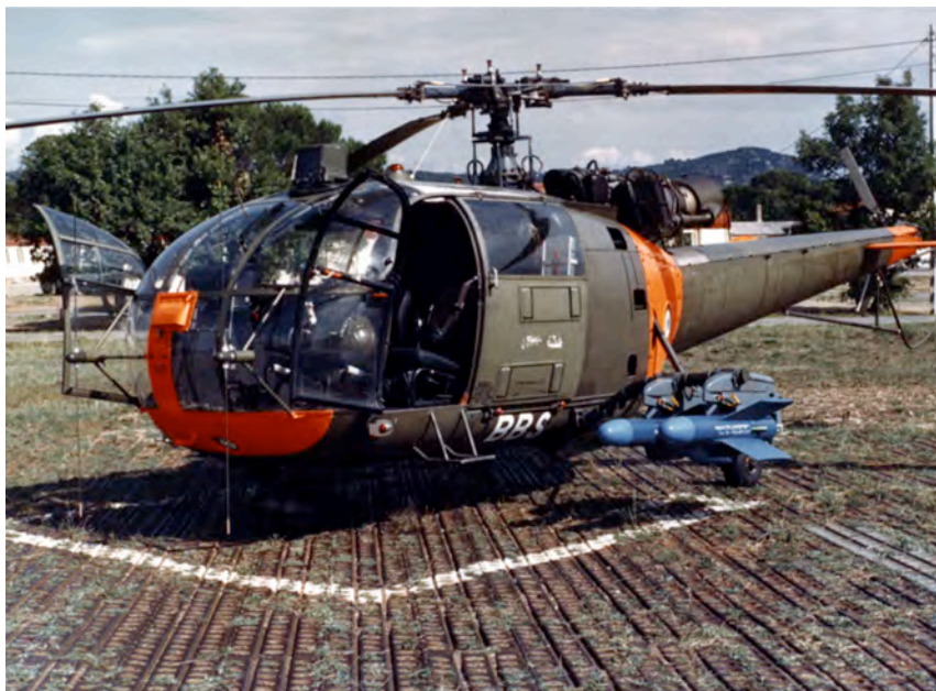
Figure 41 - SA 316 B équipée du « système » AS 12 (maquettage)
