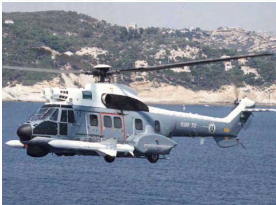
Figure 124 - SA 332 F1 équipée de ses deux missiles subsoniques Exocet
