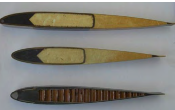
Figure 138 - Coupe des pales Écureuil et Gazelle
