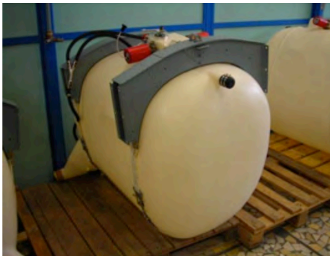
Figure 143 - Réservoir de carburant Écureuil
