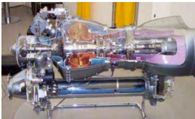
Figure 137 - Écorché du moteur Arriel 1B
