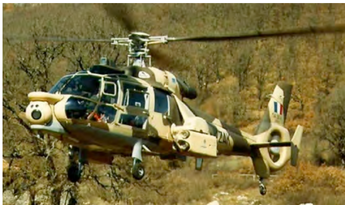
Figure 171 - Dauphin 1012 équipé du système VENUS, pour le tir du HOT de nuit
