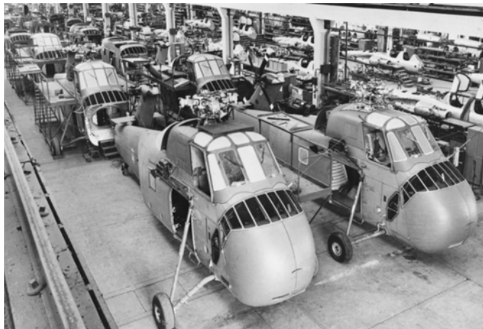
Figure 30 - Chaîne de montage S-58 à Marignane avec, à l'arrière plan, la chaîne Fouga © Photo DR/Airbus Helicopters
