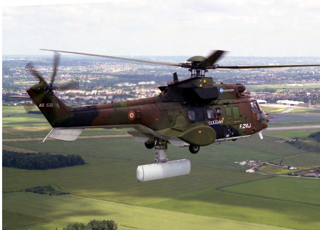
Figure 180 - Hélicoptère HORIZON antenne déployée (photo CEV)
