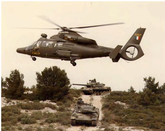
Figure 135 - SA 365M « Panther » n°6005 équipé du TM333 et du système antichar HOT © Photo DR/Airbus Helicopters
