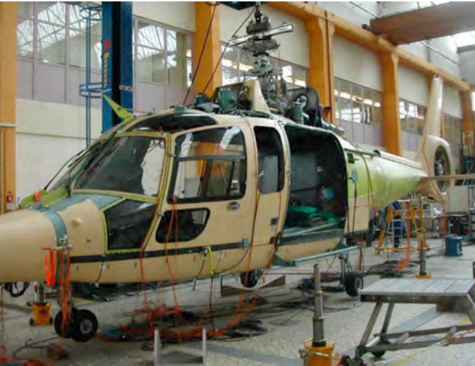
Figure 195 - Essai vibratoire au sol de l'EC 155
