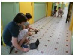
On peut alors prendre des mesures sur différents substrats (herbe, carrelage, goudron) ou sur des barres de différents matériaux (bois, plâtre, fer,...), chauffés ou pas, ce qui permet de montrer la diversité de réaction des matériaux aux vibrations ce qui être utile dans différents points du programme.
