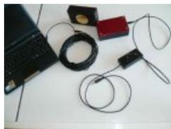
Le principe est assez simple, 2 sondes piézo sont soudées à des connectiques permettant d'obtenir un enregistrement stéréo de vibrations.
