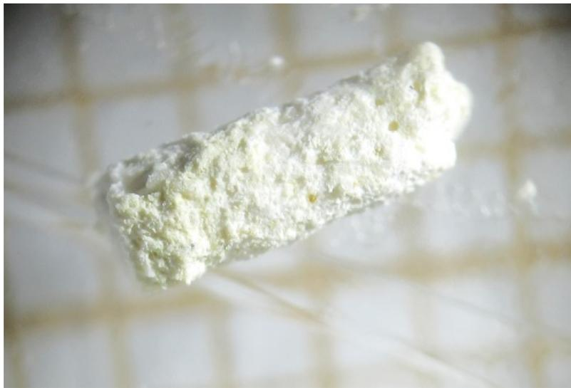
Fragment de bryzoaire extrait d'un échantillon après traitement et observé à la loupe binoculaire (papier millimétré en fond).
