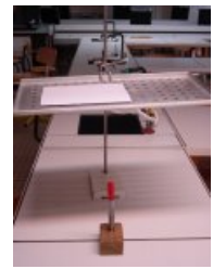
Plaque perforée soutenue par une potence au dessus d'un feutre rouge fixé à une planche
