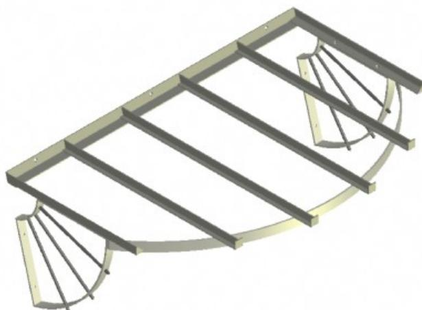
Marquise réalisée en profilés standard et assemblée par soudage et boulonnage.
