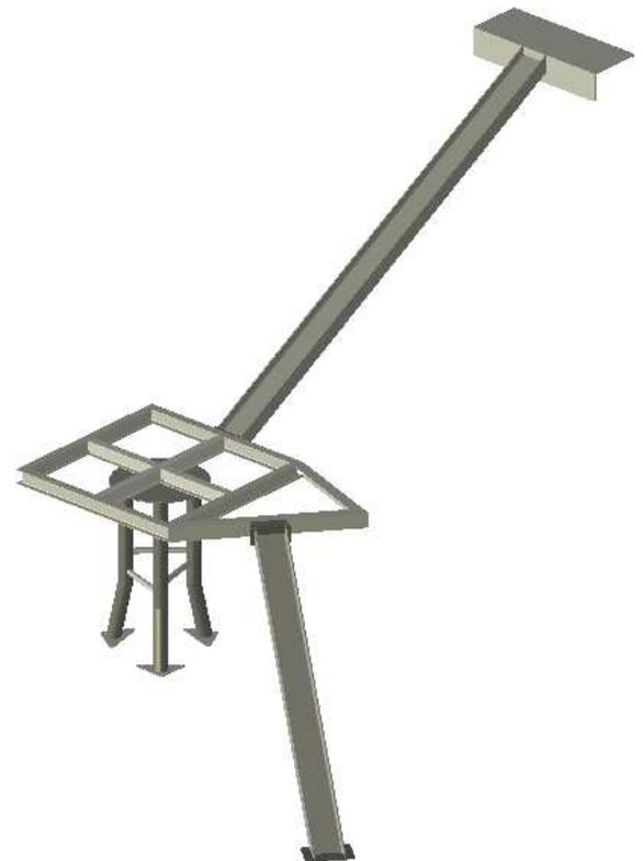
➤ **Pose - installation sur site du palier, du limon inférieur et du limon supérieur et positionnement du prototype de marche.**
