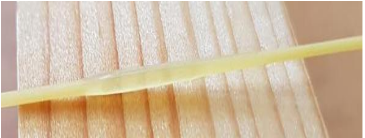
Figure 22 – Gonflement et transparence de l'élastique suite au dépôt de limonène en un point de sa surface
