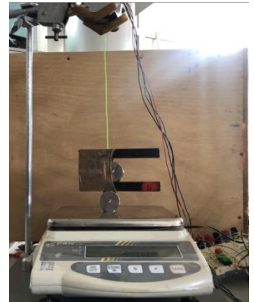
Figure 3 – Dispositif expérimental permettant la détermination du module d'Young
