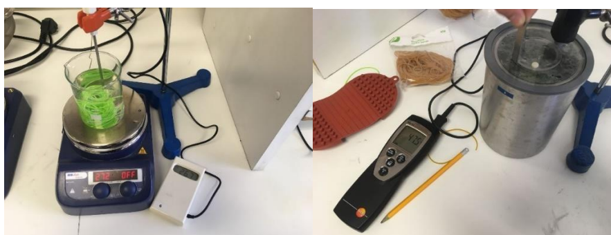
Figure 5 : Détermination des capacités thermiques des fils par calorimétrie
