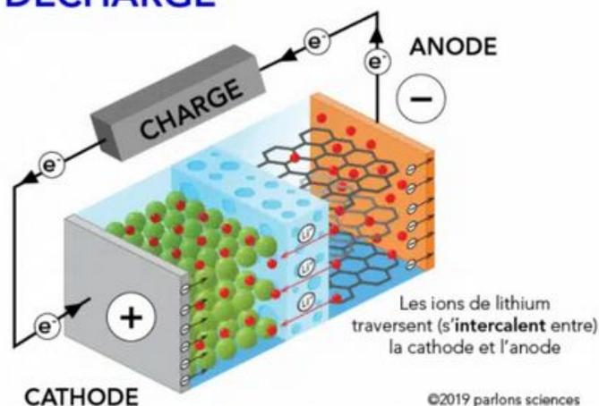
Une cellule est constituée de quatre blocs : une cathode, une anode, un séparateur et un électrolyte.
