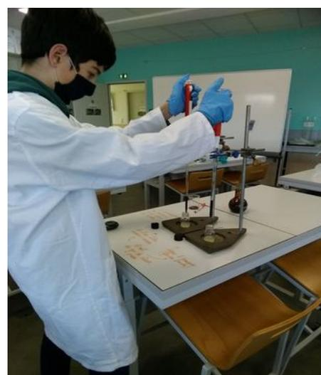
Pour notre 3eme expérience, nous avons voulu vérifier sur la cuisson dégrade diminue la quantité de vitamine C dans un aliment. Donc sur une plaque électrique, nous avons chauffé 20 ml de jus de citron frais jusqu'à ébullition. Aussitot nous avons laissé refroidir et ensuite avons versé 4 ml de permanganate de potassium.
