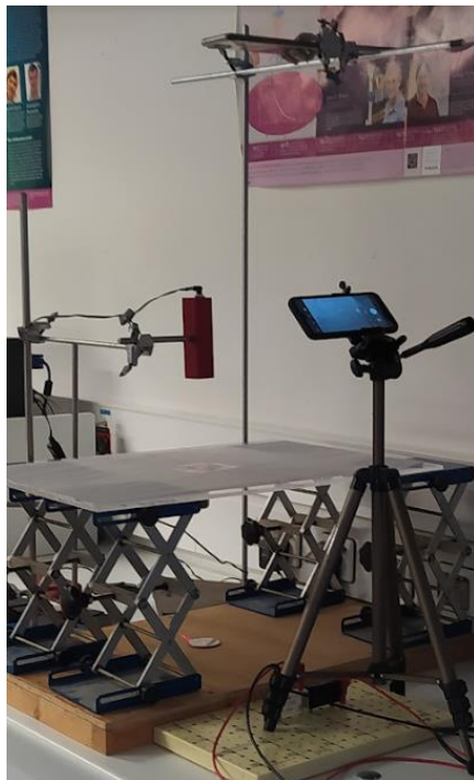
Figure 7 : Dispositif expérimental permettant la mesure de l'angle \alpha
