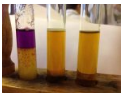
Test d'extraction du diode avec trois solvants dont le cyclohexane (photo faite par un élève)
