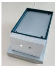
• un récepteur qui reçoit le signal et décode l'information que ce signal contient ; une prise jack  $\varnothing 3,5$  permet la connexion vers une enceinte ou le logiciel d'acquisition Audacity :
