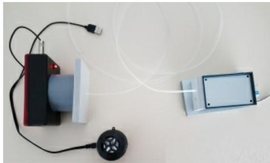
Les signaux peuvent être "analogique" (micro, lecteur mp3 ou téléphone) ou "logique" (télécommande infrarouge par exemple), ces signaux seront audibles ou visibles via une enceinte ou le logiciel d'acquisition audacity.
