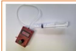
**Capteur de pression autonome 0 à 2 bars :**
