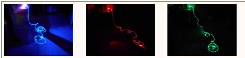
Le testeur de fibre optique génère une lumière rouge ( DEL ) qui fonctionne avec 2 piles AA et une fibre optique de 3 mm de diamètre
