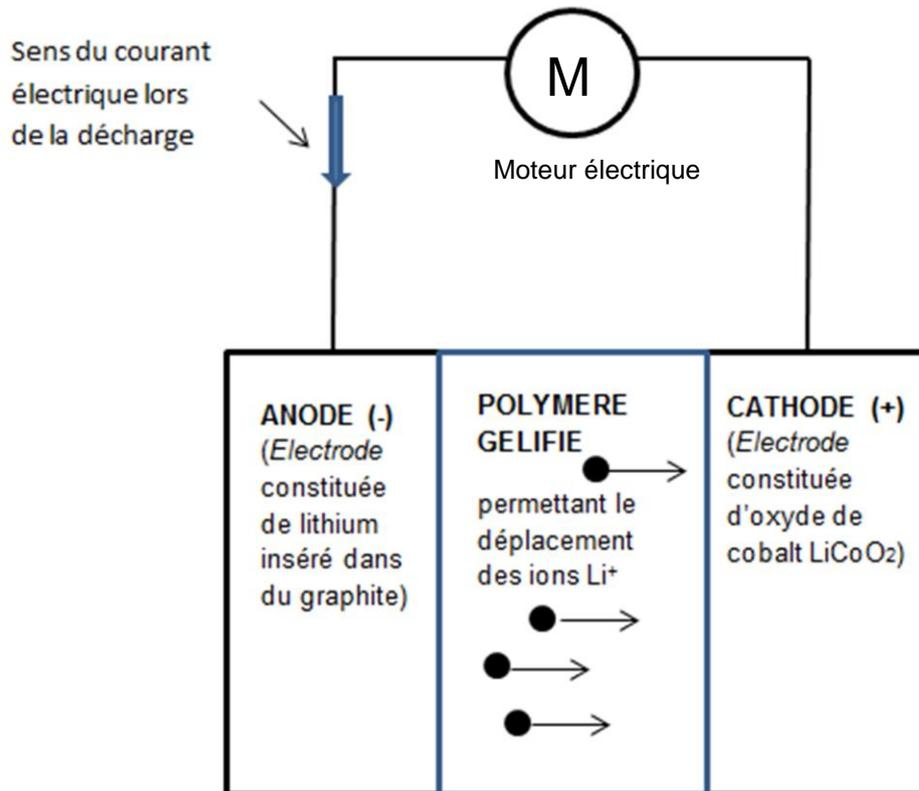
Le courant électrique est produit à l'extérieur de l'accumulateur Li-ion par la circulation d'électrons entre deux électrodes :
