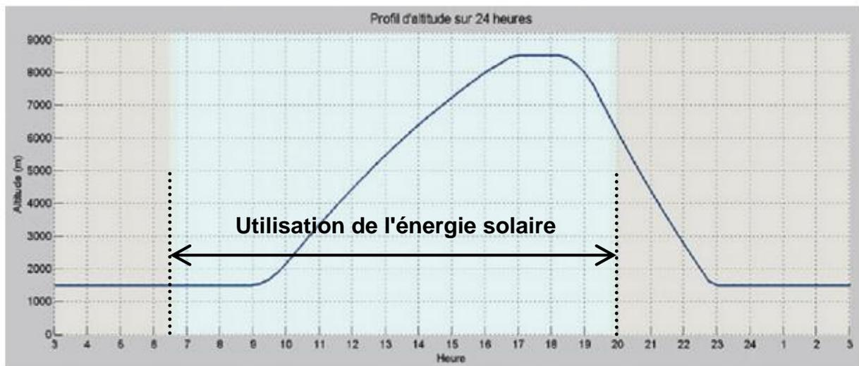
Entre 23h00 et 6h30, l'avion utilise ses batteries pour faire fonctionner les moteurs pour se maintenir à une altitude 1500 m.
