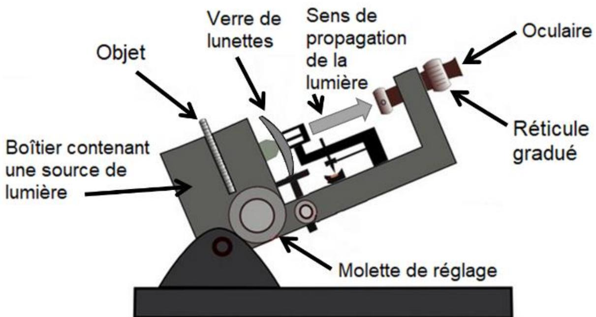
La molette de réglage permet de déplacer l'objet par rapport au verre de lunettes afin que l'image de l'objet se forme sur le réticule gradué.
