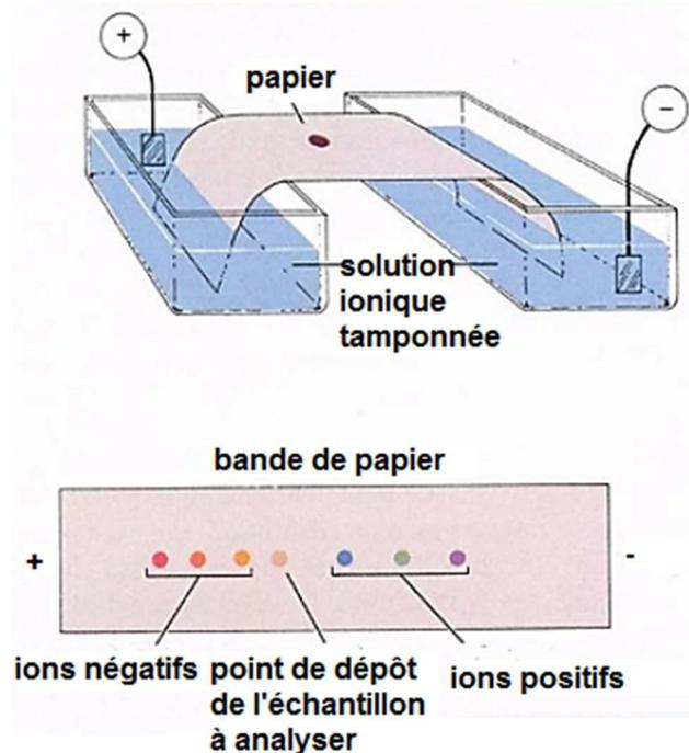
On désire séparer par électrophorèse un mélange aqueux tamponné de sérine SER et d'acide glutamique GLU.
