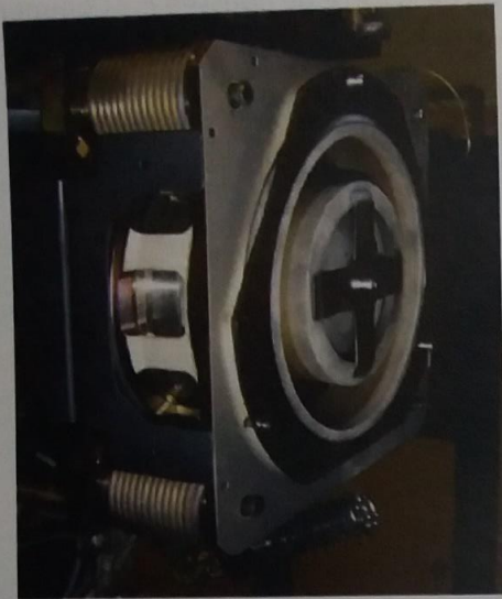
Figure 10 - Photo d'un propulseur à effet Hall et jet d'ions observable sur le banc d'essai
