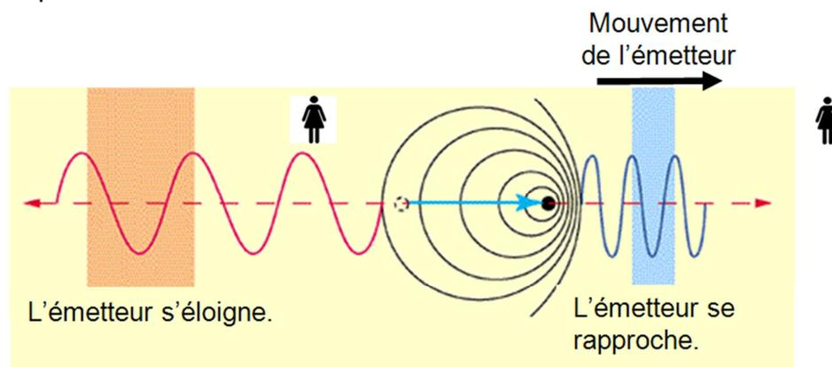
Le sous-marin envoie une onde acoustique de 3kHz en direction du dauphin. Le sous-marin se rapproche du dauphin à la vitesse  $v$  égale à  $22,0 \text{ km}\cdot\text{h}^{-1}$ .
