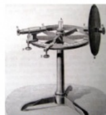
Un goniomètre servait à mesurer des angles.
