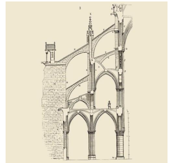
Coupe et perspective de l'intérieur de Notre-Dame de Paris et coupe transversale avec les arcs-boutants bnf
