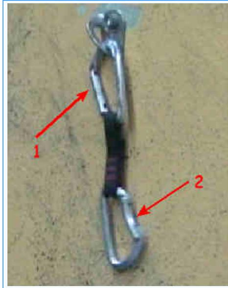
La dégaine est constituée de deux mousquetons reliés par une sangle. Le mousqueton à doigt rectiligne (1) se place sur le point d'ancrage et c'est dans le mousqueton à doigt courbe (2) que le grimpeur passe la corde d'assurage
