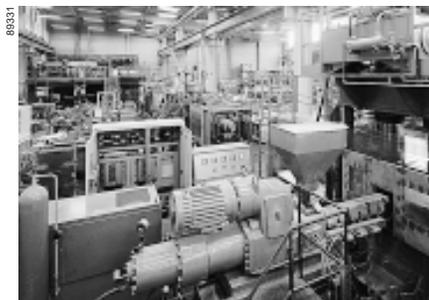
Le  $\cos \varphi$  des moteurs est en général très mauvais à vide ainsi qu'à faible charge et faible en marche normale. Il est donc utile d'installer des condensateurs pour ce type de récepteurs.
