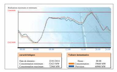
Pour faire face à ces régulations de consommation, les centrales hydrauliques et thermiques classiques sont mises à contribution (engendrant des coûts de production supérieurs aux centrales nucléaires). Cela à pour effet de provoquer des coûts variable de l'electricité.
