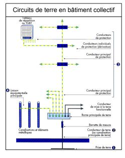
La mise à la terre fonctionnelle ne doit pas être confondue avec la mise à la terre pour la sécurité électrique. Cette mise à la terre fonctionnelle à pour but de mettre des matériels au potentiel de la terre pour assurer leur fonctionnement. La couleur des conducteurs sera différente du vertjaune et ceux-ci seront raccordés directement à la terre sur la borne principale.
