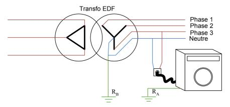
Le schéma T T est le système imposé dans les installations alimentées par le réseau de distribution publique basse tension
