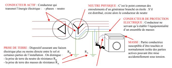
COURANT DE DEFAUT : Courant résultant d'un défaut d'isolation et qui a pour effet de provoquer un accroissement du potentiel du neutre . Il existe deux types de courants de défaut :
