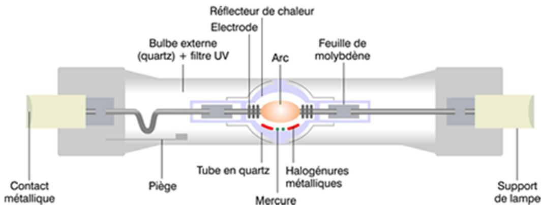
De température de couleur blanche, leurs performances et leurs compacités (de 20w à 150w) ont permis à ces sources de pouvoir s'intégrer dans des luminaires de tailles réduites et de pouvoir remplacer les lampes halogènes peu efficaces et gourmande en énergie.
