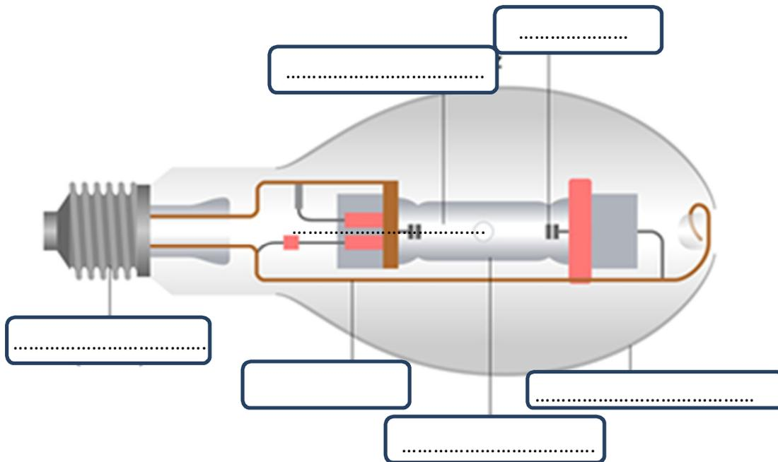
Ces lampes ont eu leurs heures de gloire. Elles permettaient de remplacer les lampes incandescentes de 1000 W sous condition d'y ajouter un ballast (ou self). Elles n'ont que rarement été utilisées pour d'autre application du fait que leur très mauvais rendu des couleurs : IRC 50 et un faible rendement lumineux : entre 36 et 58 lm/W
