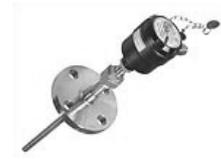
**La Sonde PT100** : résistance variable en platine (*PT*) en fonction de la température du milieu ( $100 \Omega$  à  $0^\circ\text{C}$ ). Etalonnage à des températures connues (changement d'état) et à une pression donnée. ( $P_{\text{atm}}$ )
