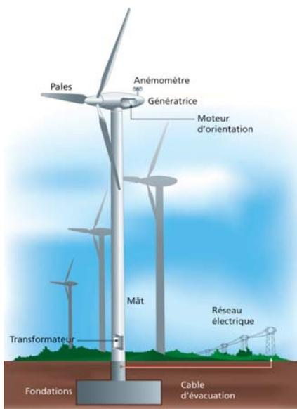
Principe de fonctionnement d'une éolienne raccordée au réseau
