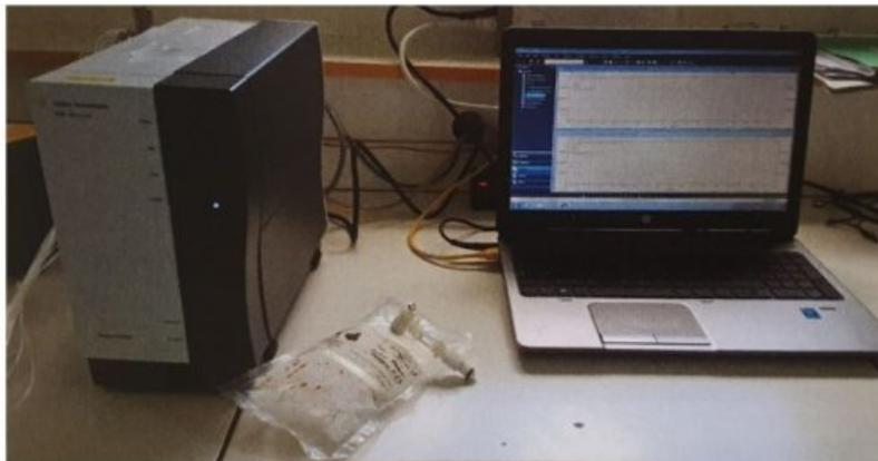
Micro-chromatographe phase gazeuse (MicroGC 490 Agilent)
