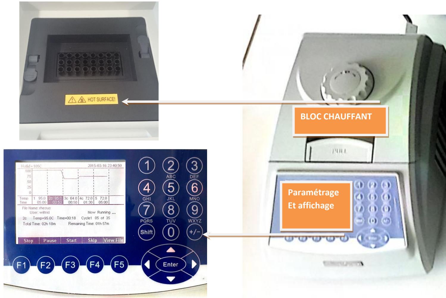
Principe de fonctionnement et photo du thermocycleur BIOER
