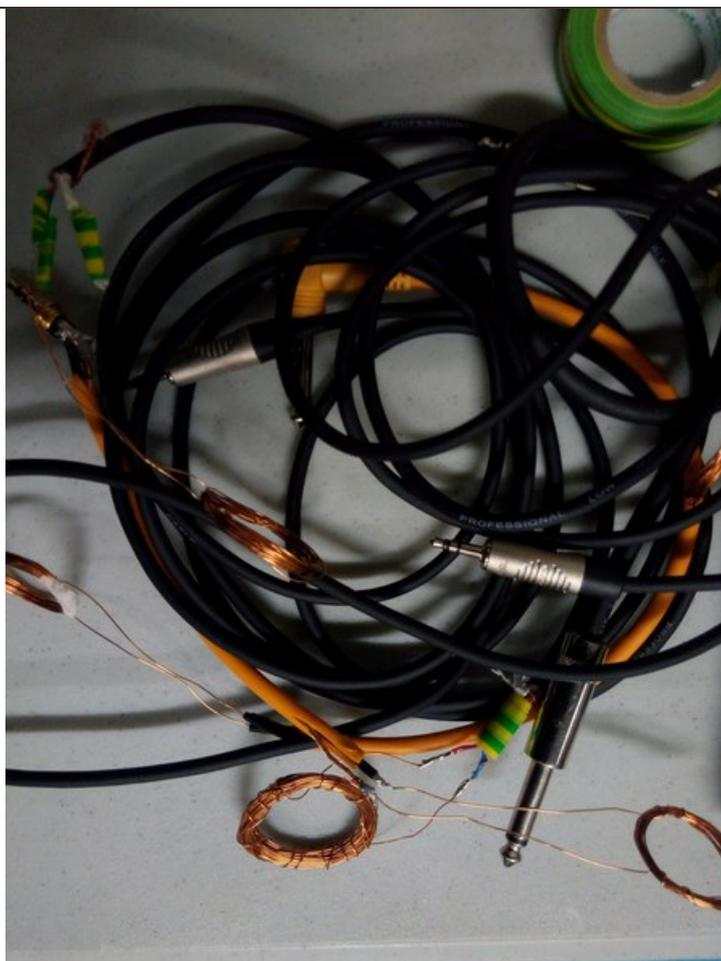
quelques fils de cuivre enroulés soudés à une prise jack
