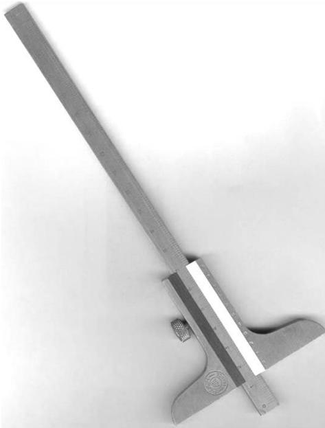
Cet appareil est une variante de calibre à coulisse. Il permet la mesure directe des profondeurs.
