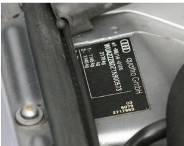
La plaque constructeur (*image de droite*), sur laquelle est inscrit le numéro de châssis (que l'on doit impérativement retrouver sur la carte grise), **est située dans le compartiment moteur sur une plaque fixée à gauche, (en étant face à l'auto).**
