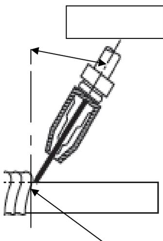
Le fil fusible doit s'appuyer sur le dernier point afin d'éviter de produire un trou.
