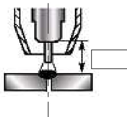
Le fil fusible doit être dans le même axe de symétrie que la zone de soudure.
