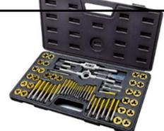
Le pas d'une vis ou d'un écrou peut s'avérer être détérioré pour plusieurs raisons. Il est donc parfois nécessaire de le remettre en état .
