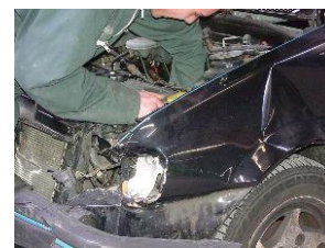
Corrosion sur l'aile ARG
