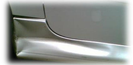
Partie du bas de caisse gauche à remplacer du véhicule Peugeot 206
