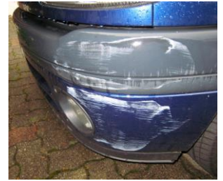
Éraflures profondes sur la partie gauche du bouclier avant
