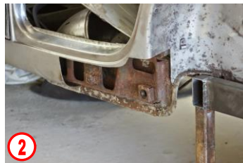
Découpe de la partie corrodée
