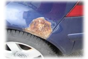
Corrosion sur l'aile ARG
