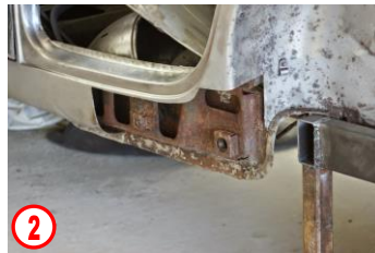
Découpe de la partie corrodée
