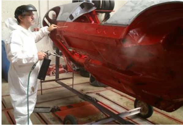
Application de la cire corps creux dans les cavités de la carrosserie
