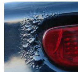
Piqûres de rouille sous le film de peinture
