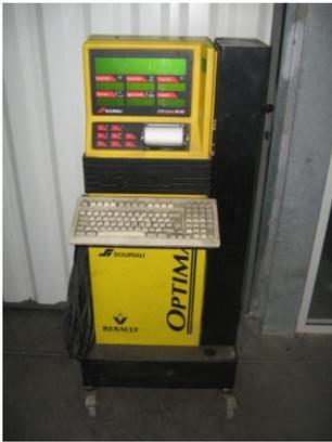
Pour répondre aux normes d'antipollution, les centres de contrôle technique utilise des analyseurs type 4 gaz d'échappement. (Voir photo de gauche).
