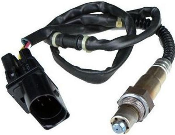
L'EURO 5 exigeant des normes de dépollution encore plus sévères, le moteur EP6CDT s'est doté d'une sonde à oxygène amont à large bande. Ce type de sonde permet de mesurer un Lambda bien supérieur à 1 dans les modes stratifiés mais aussi pour les moteurs fonctionnant avec un excédant d'air comme les moteurs Diesel.
