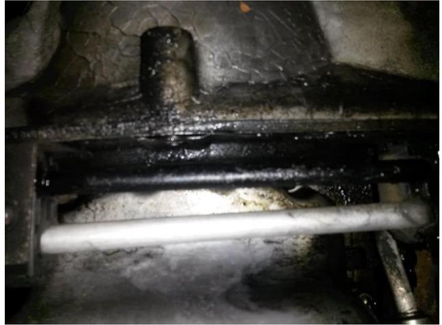
Suite aux traces d'huile repérées entre la cloche d'embrayage et le bloc moteur, j'ai décidé d'enlever la tôle protectrice du volant moteur pour valider le cheminement de la fuite.
