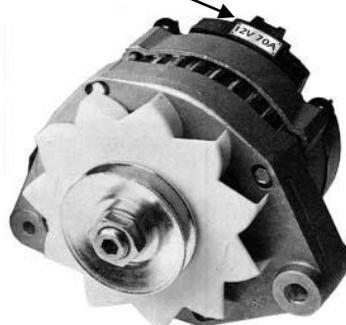
Quand le moteur tourne, l'alternateur fournit une tension voisine de 14V. Les consommateurs fonctionnent donc sous cette tension.
