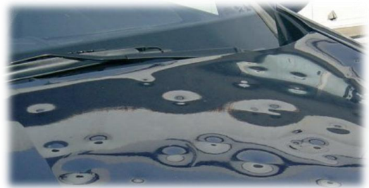
Déformations vue en contre jour
