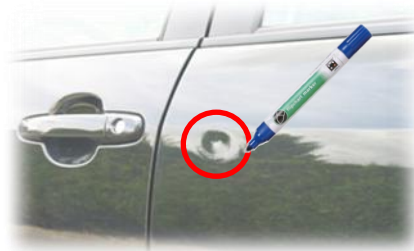
Repérage des défauts
