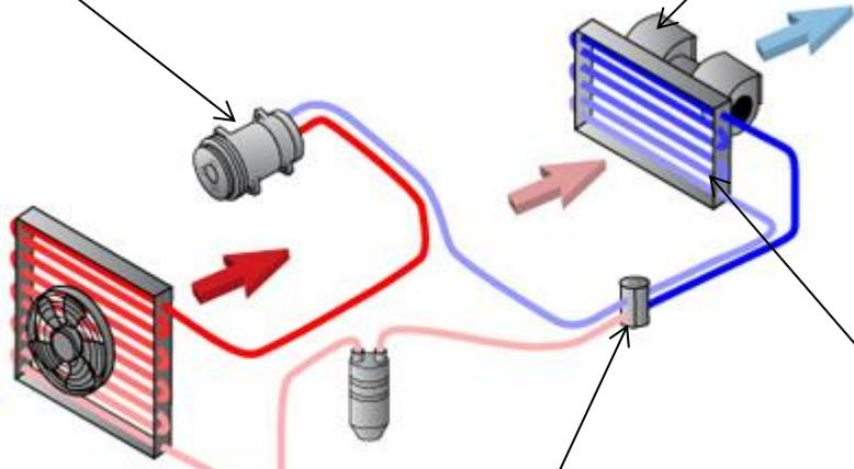
Nom de la pièce :Capteur de pression fluide réfrigérant
