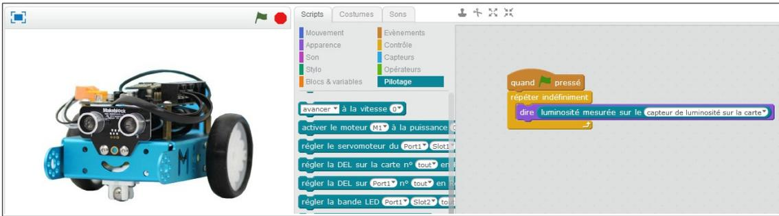
On clique sur le drapeau vert, ici avec le capteur de luminosité découvert
